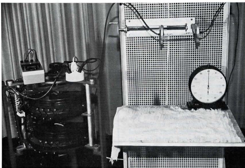
Bild 1. Versuchsaufbau nach DIN 57 710, Teil 6 u. 10/VDE 0710, Teil 6 u. 10.
