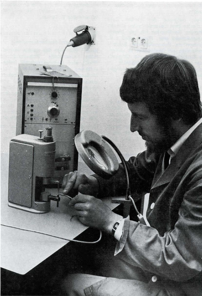
Bild 4. Elektrisches Punktschweißen von Thermoelement-Meßspitzen.
