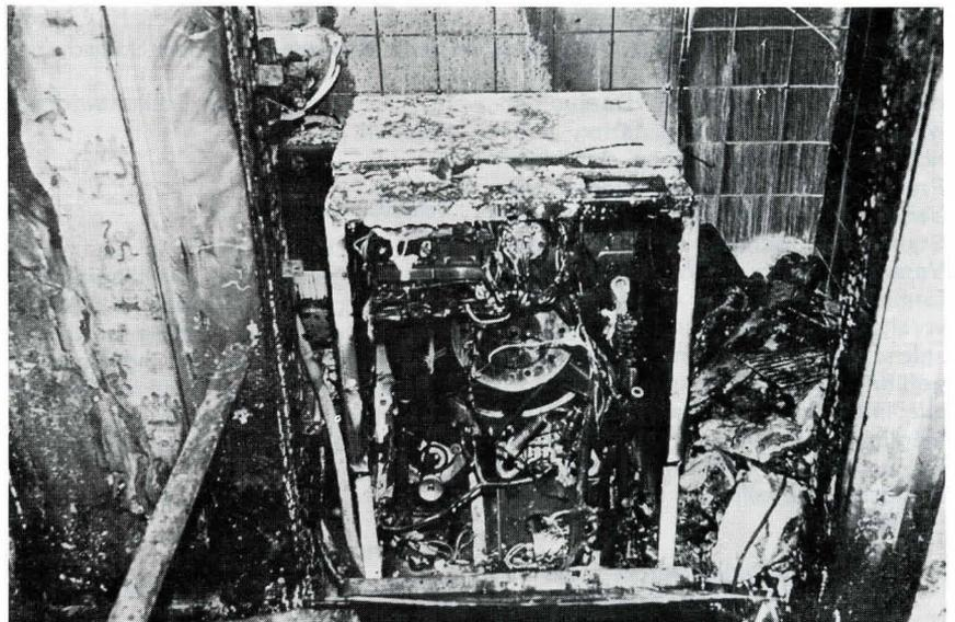
Waschmaschine. Lichtbogen führte hier zum Brandschaden.
