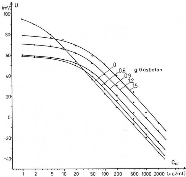
Bild 8. Abweichungen bei potentiometrischen Chloridbestimmungen durch Adsorption von Chlorid an Gasbeton.
