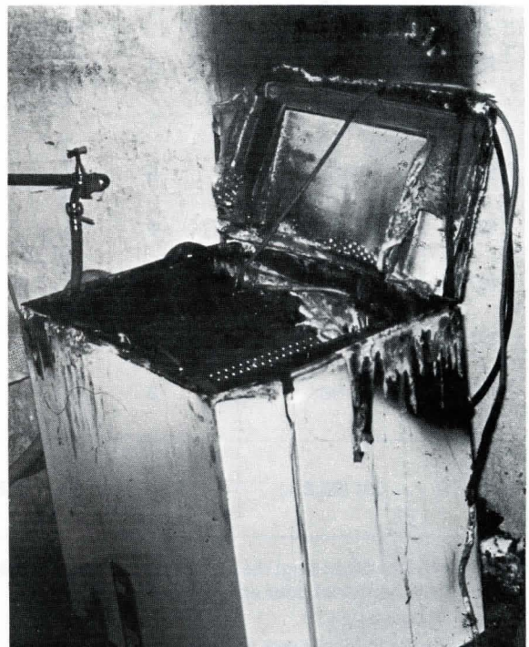
Bild 3. Waschmaschinenbrand Ursache: Defekte Programmsteuerung
