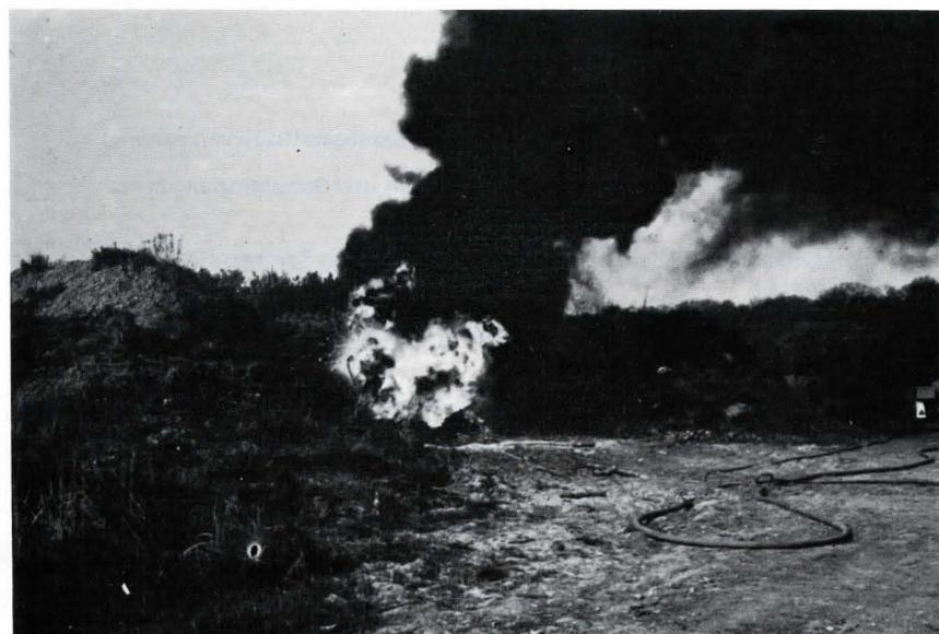
Bild 6. Brandversuch mit 1250 kg einer Nitroverbindung in einem big bag; Brandverlauf.
