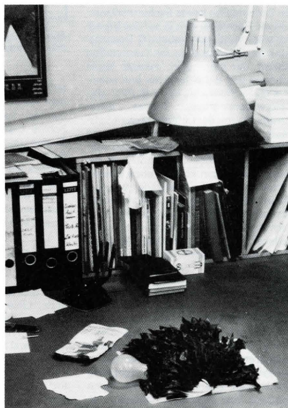
Abb. 1. Glühlampe als „Beinahe-Brandstifter“. Der Glaskolben löste sich wegen mangelhafter Kittung vom Sockel, fiel aus der Tischleuchte heraus und entzündete ein aufgeschlagenes Buch. (Keine Lampe des auf dem Karton im Hintergrund genannten Herstellers!) (Bildnachweis: D. Graf, Museum für Völkerkunde, SMPK)
