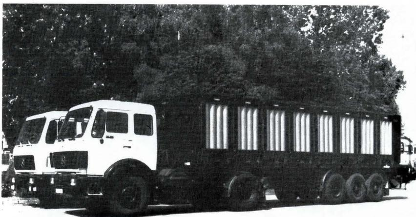
Bild 7. Acetylen-Trailer\*)
