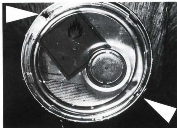
Bild 1. Deutlich sind die gewaltsam eingeschlagenen Löcher (Pfeile) im Behälter zu erkennen.
