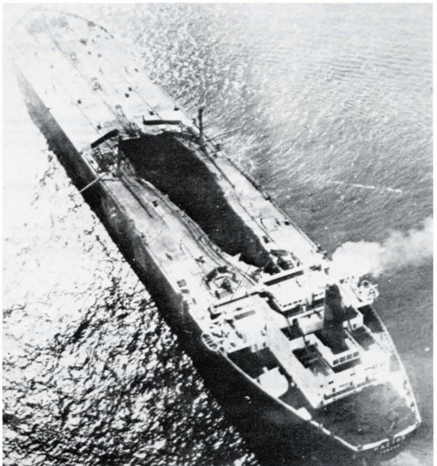
Bild 1. Ende der sechziger Jahre fanden mehrere Explosionen auf Großtankern statt, die – wie hier im Bild – zum Aufreißen des Schiffsrumpfes geführt haben. Als Zündursache werden elektrostatische Entladungen infolge des aufgeladenen Tröpfchennebels beim Waschen der riesigen Rohölbehälter vermutet [2].
