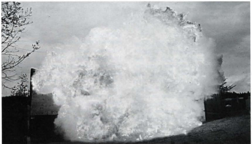
Bild 2. Die Zündempfindlichkeit von Staubwolken und die Heftigkeit von Staubexplosionen wurden während langer Zeit unterschätzt. Die Auswirkungen von Staubexplosionen übertreffen in mancher Hinsicht diejenigen von Gasexplosionen. In diesem Bild ist der Feuerball nach der Zündung einer Staubwolke, gebildet aus ca. 4 kg fein verteilten Pigmentpartikeln, festgehalten [55].
