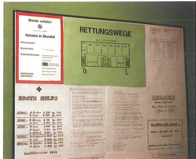
Bild 3 Aushangbeispiel für eine Brandschutzordnung Teil A
