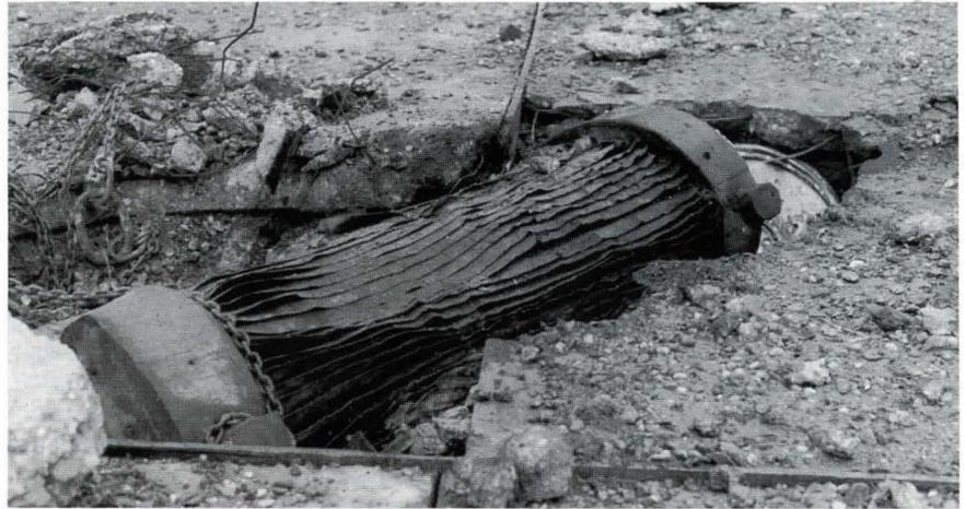
Bild 7: 4t-Modell eines BE-Behälters nach einem Fall aus 200m Höhe auf eine Betonplatte; Behälter weist keine wesentliche Beschädigung des eigentlichen Behälterkörpers auf und ist noch genügend dicht.
