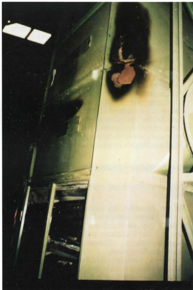
lichen Sinn eine gewisse Eigenständigkeit erreichen. Durch den Summationseffekt von äußerer Wärmezufuhr, oxidativen Reaktionen und Maillard-Reaktionen kann dabei in Zusammenhang mit aus Verklumpungen resultierendem Wärmestau die Entzündungstemperatur des Materials erreicht werden. Hiermit dürften die Glutbrandentstehungen (auf der Absaugseite der Körner-trockner) eine Erklärung finden.
