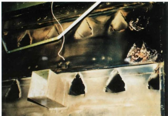
*Lackzerstörungen an der Trocknersäule infolge eines Glutbrandes im Trocknungsgut.*
