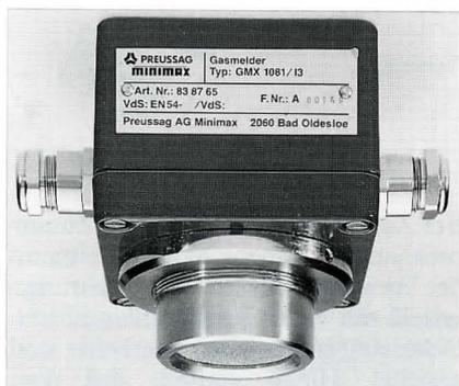
Auch dieser Sensor reagiert wie die beiden zuvor beschriebenen nur im aufgeheizten Zustand. Die Reaktionsschicht besteht aus einem Zinnoxid-Halbleitermaterial, das durch die Dotierung mit Palladium, Rhodium oder Platin in seiner Empfindlichkeit beeinflusst werden kann und somit für den jeweiligen Einsatzfall ausgesucht wird.
