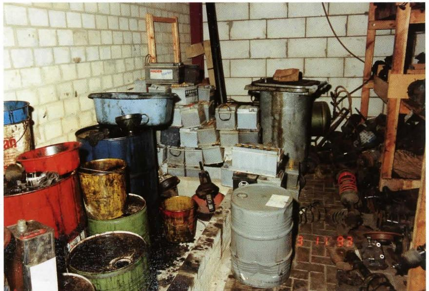
Abb. 5: Unsachgemäße Lagerung von besonders überwachungsbedürftigen Abfallstoffen
