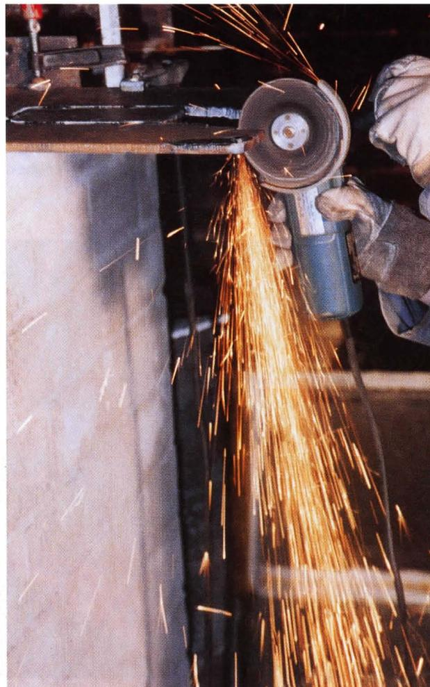
Bild 1, Trennschneiden
