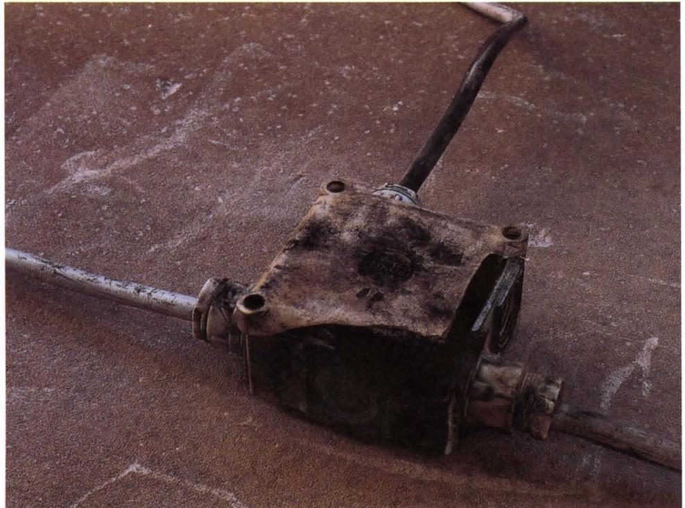
**Abb. 7:** Beschädigte elektrische Betriebsmittel können den erforderlichen IP-Schutz aufheben und Lichtbogen – Brände durch Beeinträchtigung der Luft- und Kriechstrecken verursachen.
