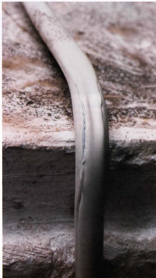
**Abb. 6:** Durch Überstrom thermisch zerstörte elektrische Leitung.
