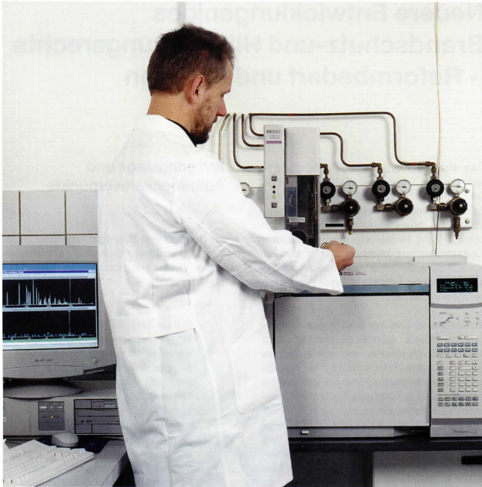
Siegfried Stief bei einem Nachweis von flüssigen Brandlegungsmitteln mit der GC/MS.
