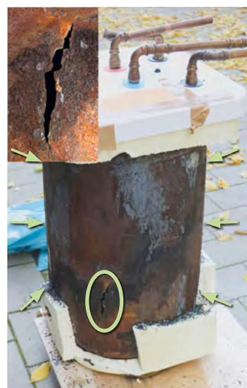
Auch hier bestätigte die Laboruntersuchung einen stark überhöhten Innendruck, der den Stahlbehälter zum Platzen gebracht hatte.
