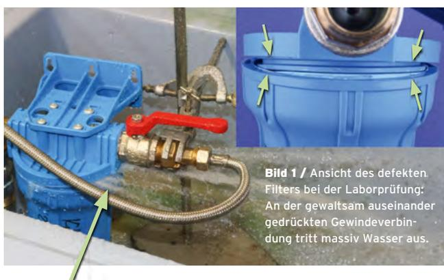
**Bild 1 /** Ansicht des defekten Filters bei der Laborprüfung: An der gewaltsam auseinander gedrückten Gewindeverbindung tritt massiv Wasser aus.
