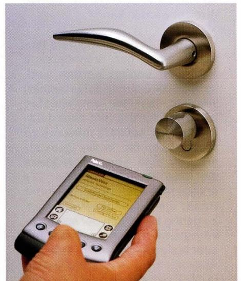
gen Begleiter durch einen einzigen Transponder ersetzt. Diese „digitale Fusion“ aus Transmitter (Sender) und Responder (Empfänger) funktioniert als völlig drahtloser Türöffner. Er sendet Funksignale an die Schließelektronik im Türknauf aus und kommt deshalb auch ganz ohne Bart sehr gut zurecht. Plötzlich können per Knopfdruck auf den Transponder alle Türen mit nur einem „Schlüssel“ problemlos geöffnet werden (**Bild 1**).
