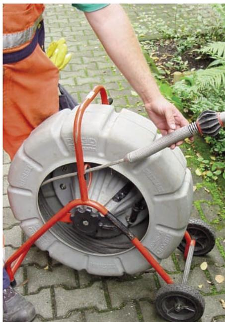
**Bild 1:** Schiebekamera zur optischen Überprüfung von Abwasserrohren. Der Kamerakopf wird mit dem flexiblen Kabel durch das Rohr geschoben.
