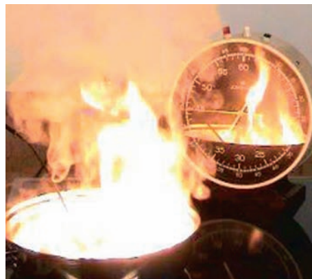
Abb. 5: Nach der Überhitzung des Öls bzw. Fetts in der Pfanne tritt eine Entzündung auf. Leicht können dann andere Gegenstände in Brand gesetzt werden. Meist greift der Brand primär auf den Fettfilter der Dunstabzugshaube über.
