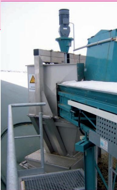
**Bild 6:** Einbringen von Maissilage über einen Trichter direkt in den Fermenter einer Biogasanlage
