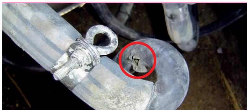
**Bild 15:** Ursache für den Schaden war ein defektes Kabel mit nachfolgendem Wassereintritt.
