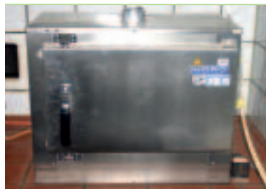
Bild 4: Ofen im IFS-Labor zum Prüfen des Selbstentzündungsverhaltens von Stoffen.
