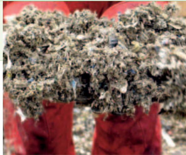
Bild 8: Zerkleinertes Recyclingmaterial aus Kunststoff.
