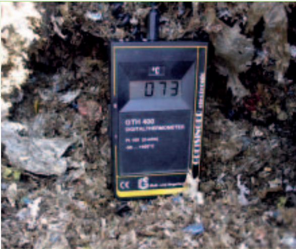
Bild 7: Die Temperatur in der Schüttung des Recyclingmaterials beträgt noch Tage nach dem Brandschaden 73 °C.
