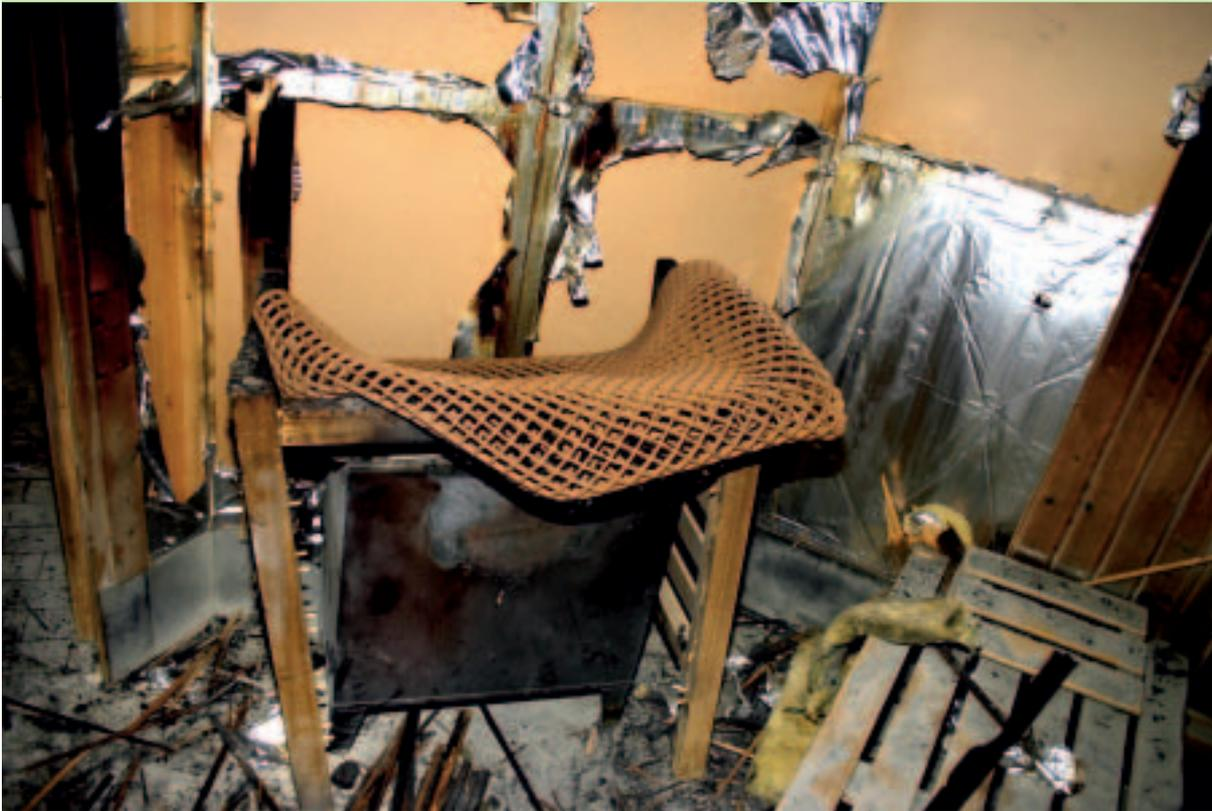
**Bild 3:** Bei einer Kontrolle der Sauna vor dem Einschalten wäre wohl die zusammengelegte Fußbodenmatte aus Kunststoff (Rekonstruktion), die durch die Reinigungskräfte auf den Saunaofen zum Durchwischen „hochgelegt“ wurde, aufgefallen.
