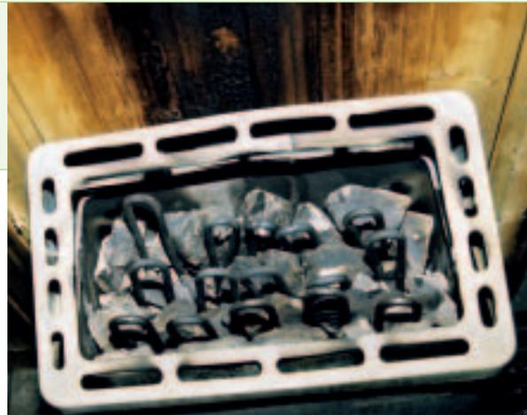
**Bild 6:** Bei der „noch nicht“ in Flammen aufgegangenen Nachbarsauna waren aufgrund der Unterschreitung der Sicherheitsabstände die oberen Querstreben des hölzernen Schutzgitters bereits verkohlt, so dass es über kurz oder lang auch in dieser Sauna zu einem Brandschaden gekommen wäre.
