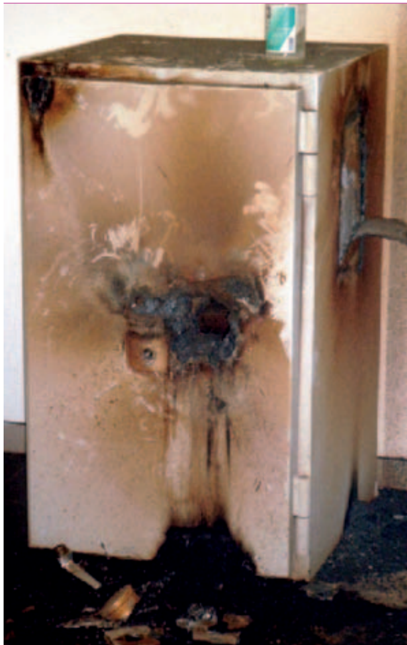
Bild 4: Tresor mit den Spuren der Öffnungsversuche.
