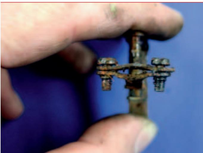
**Bild 3:** Die Schrauben der Zugentlastung sind fast bis zum Anschlag festgedreht.
