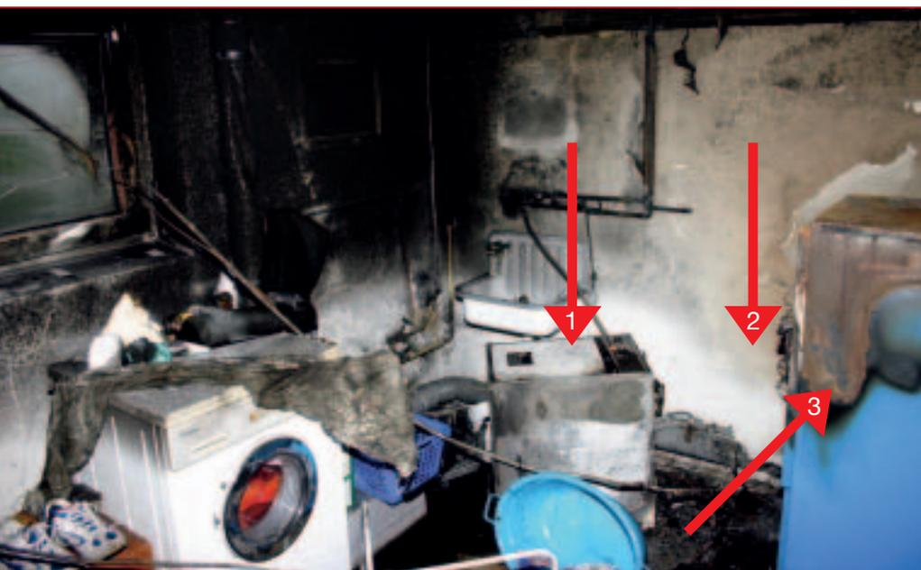
**Bild 1:** Die Waschmaschine, die zum Schadenzeitpunkt in Betrieb war (1), ihr ursprünglicher Standort (2) und der Heizkessel (3).
