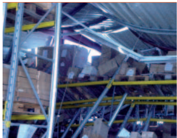
Bild 1 und 2: Stahlskeletthalle – Ausführung mit normgerechter Schneelastannahme („echter“ Schneedruckschaden).
