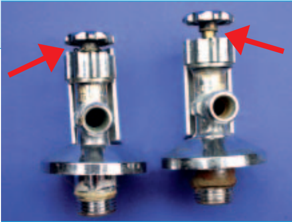
Bild 3: Eckventile, durch den hohen Druck bei Frost geplatzt. Die Schraubkappen aus verchromtem Kunststoff sind im Gewindeübergang abgerissen (Pfeile). Dadurch wurde der Ventileinsatz herausgedrückt und Wasser konnte austreten.
