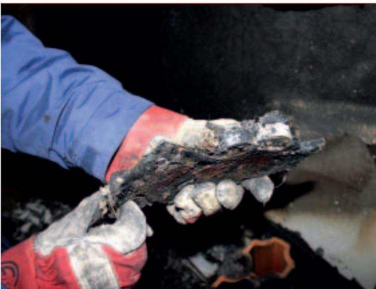
**Bild 3:** Die Teelichte in der Kunststoffschmelze.
