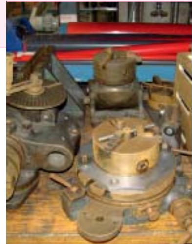
Bild 5: Maschinenzubehör mit Korrosionsansatz
