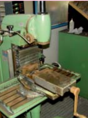
Bild 6: Fräsmaschine mit Rostansatz an blanken Metallteilen
