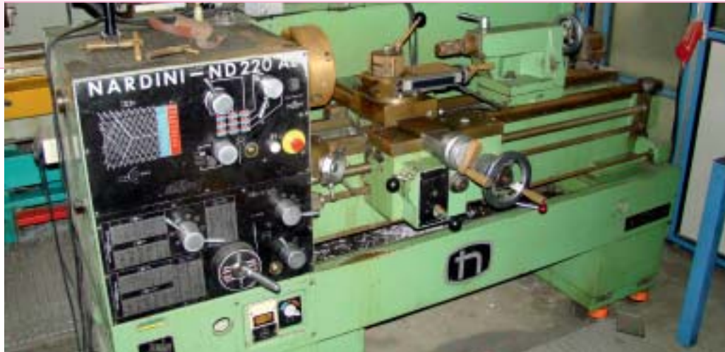
Bild 7: Drehmaschine mit Rostansatz an blanken Metallflächen
