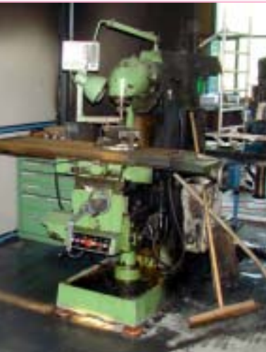
Bild 3: Fräsmaschine durch Brandeinwirkung total beschädigt
