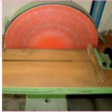
Bild 10: Schleifmaschine mit Rostansatz
