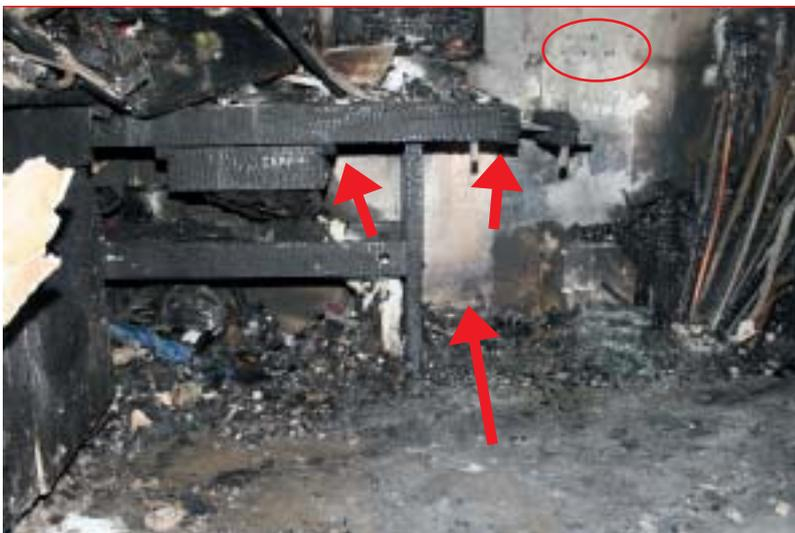
**Bild 3:** Blick in Richtung Hobelbank: Dahinter ist die Wand aufgeheilt (Pfeile). An der Wand daneben war eine Halterung mit Steckdosen befestigt (Ellipse).
