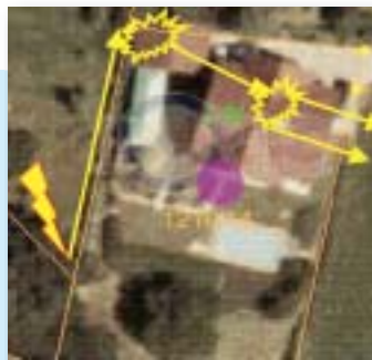
Bild 11: Lageplan des betroffenen Objektes mit Kennzeichnung der Blitzeinschlagsstelle und den nachvollziehbaren Strompfaden bis zur Auskopplung in die Versorgungssysteme (Quelle: Land OÖ DORIS).
