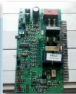
Bild 5, Bild 6: Der Kreis markiert Überschlagespuren von der Betonarmierung auf die Führungsschiene. In Bild 6 ist die abgesprengte Platine ersichtlich. Der in der Steckdose integrierte Überspannungsschutz und die Verkabelungen waren unbeschädigt.
