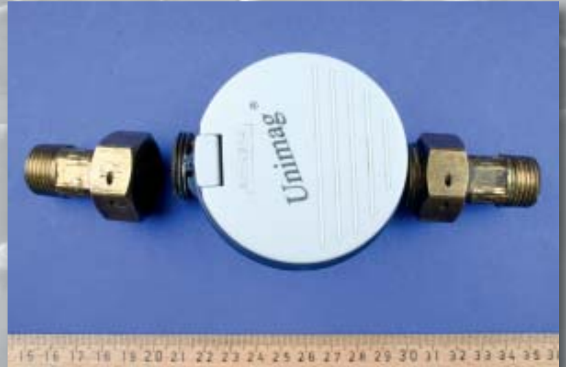
Bild 1: Die Wasseruhr – ein Gewinde ist gebrochen
