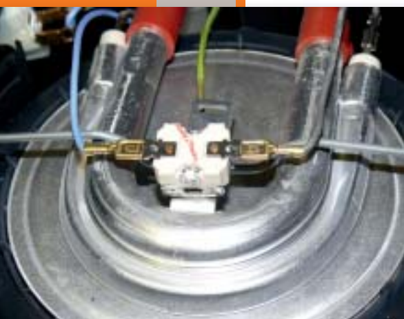
Bild 5 | Vergleichsansicht einer unversehrten Bodeneinheit mit einem intakten Sicherheitstemperaturbegrenzer (in Bildmitte).
