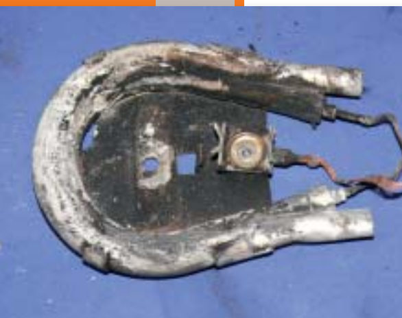
Bild 4 | Die Bodeneinheit der Kaffeemaschine ist erheblich beschädigt. Das Leichtmetall der hufeisenförmigen Heizungsbaugruppe weist partielle Abschmelzungen auf. Der Sicherheitstemperaturbegrenzer ist zerstört.
