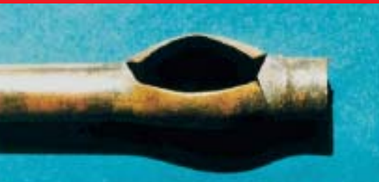
Bild 5 | Frostschaden an Wasserleitung, Quelle: schadenprisma 4/1997
