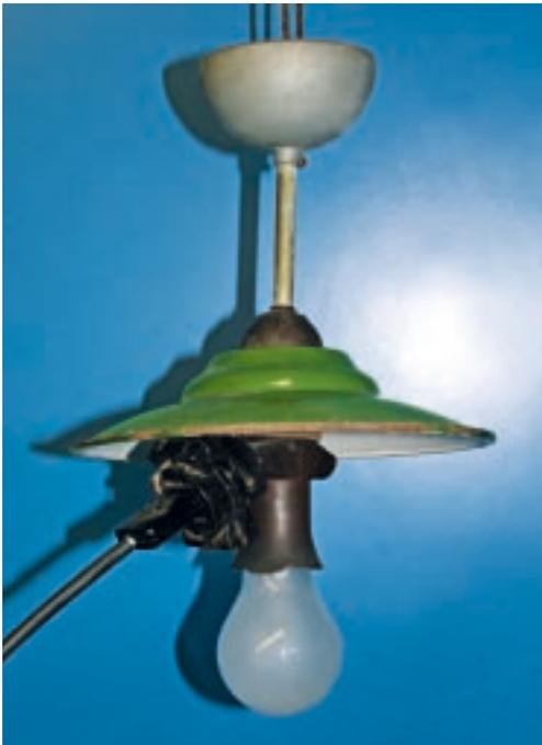
**Bild 1** | Ähnlich dieser Leuchte aus dem Fundus des IFS sahen erste Leuchten aus. An eine an der Fassung befindliche Steckverbindung war zum Beispiel ein Bügeleisen anzuschließen. Wandsteckdosen waren anfangs rar.
