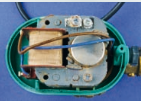
Bild 2 | Korrosionsspuren im Inneren
