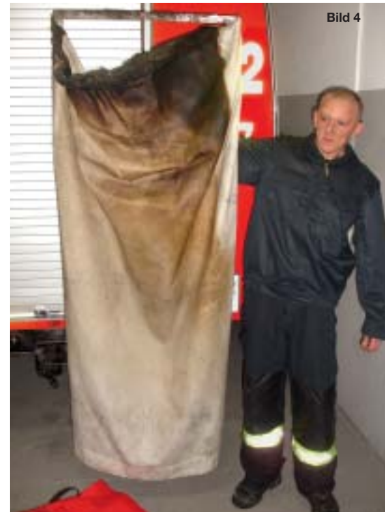
Bild 4 | Der bei dem Brand zerstörte mobile Rauchverschluss erfüllte seinen Zweck und trug mit Sicherheit zur Rettung der Kinder bei.
