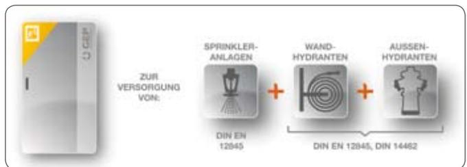
**Bild 10 |** Beispiel kombinierte Wasserversorgung
