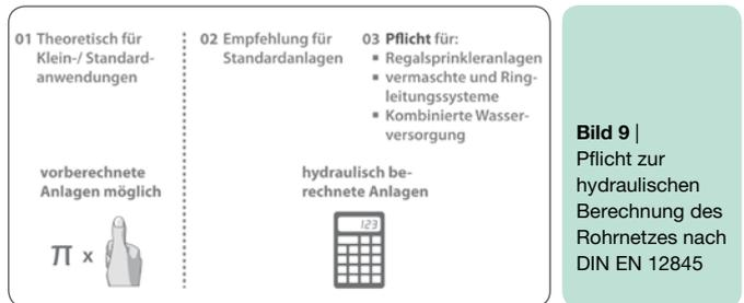
**Bild 9 |** Pflicht zur hydraulischen Berechnung des Rohrnetzes nach DIN EN 12845
