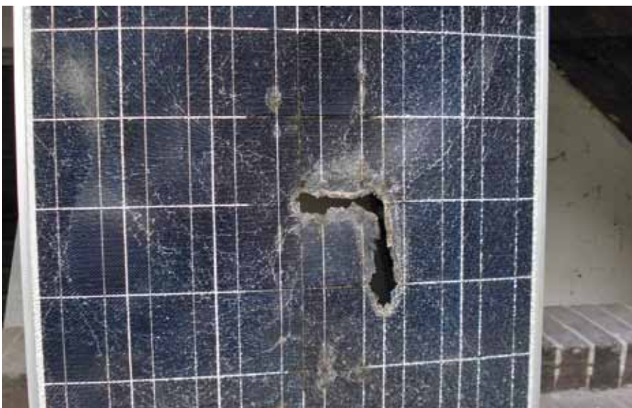
Unten: Lichtbogenschaden an einem PV-Modul, Quelle: Schaden VGH
