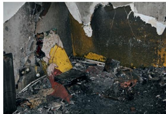
**Bild 4** | Reste der Unterhaltungselektronik in der Zimmerecke: Im Schutt sind die diversen Geräte noch erkennbar. Zu sehen ist auch, dass für diese nur zwei Steckdosen (links im Bild) zur Verfügung standen. Daher kamen Mehrfachsteckdosen zum Einsatz.
