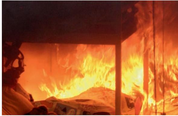
**Bild 1** (links) | Typisches Kinderzimmer (nachgestellt von der Bundesanstalt für Materialprüfung für den Brandversuch): Gut sichtbar sind die vielen Spielzeuge aus Kunststoff, der PC und der insgesamt kleine Raum, auf den sich die Brandlast konzentriert.
