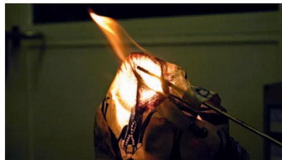
**Bild 5** | Baumwollstoff über einer eingeschalteten Halogenleuchte gerät in Brand: In diesem Fall wurden durch das Zuhängen einer Halogenleuchte Temperaturen von über 300°C erreicht. Dadurch kam es zur Entzündung des Stoffes.
