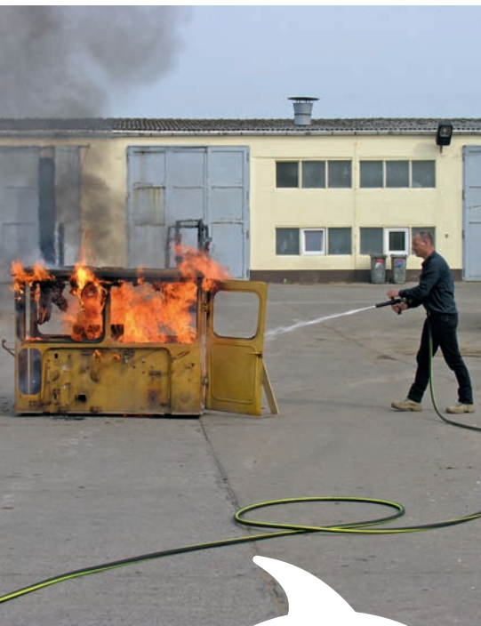
Bild 4 | Demonstration des Löschvorgangs an einer brennenden Fahrzeugkabine – Vorbrennzeit: 3 Min.
