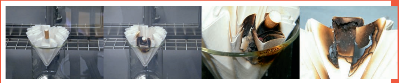
Bild 7 | Dokumentation des Abbrandverhaltens einer Zigarette, die mit einer Neigung von ca. 70° in Faltenfiltern positioniert wurde (linke zwei Teilbilder). Zum Schluss ist die Zigarette bis zum Filter verbrannt (zweites Teilbild von rechts). An den Faltenfiltern ist es zu einer deutlichen Einbrennung gekommen (rechtes Teilbild).
