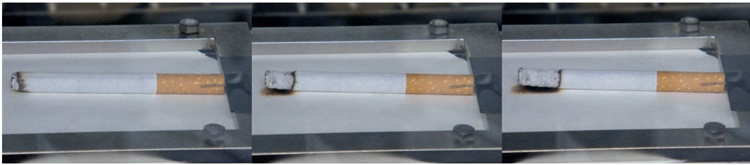
Bild 3 | Dokumentation des Abbrandverhaltens einer Zigarette, die waagrecht auf zehn Lagen Filterpapier positioniert wurde.
