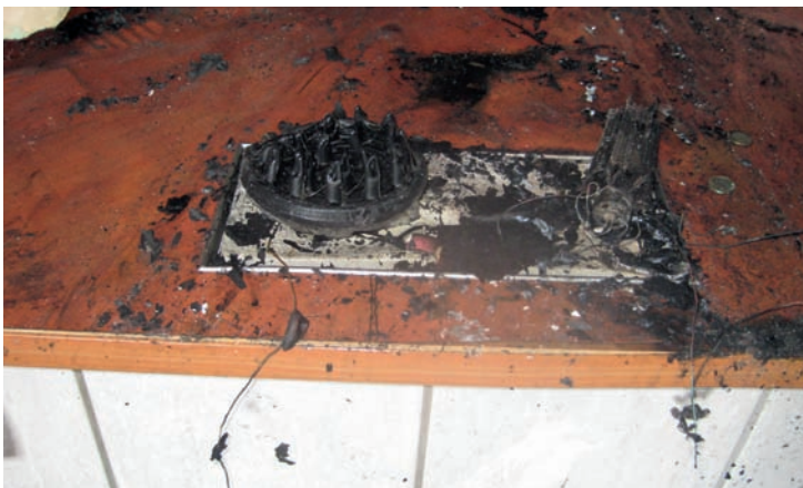
Bild 3 | Brand zur nachtschlafenden Zeit in einem Wohnhaus. Ein Haartrockner schaltet sich aufgrund eines mangelhaften Schalters selbstständig ein. Dieser Fehler führte später zu einem Produktrückruf des Anbieters. Das zweite Bild zeigt ein Vergleichsgerät.
