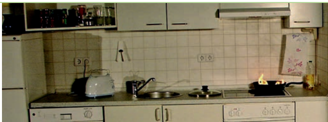
Bild 3 a-c | Nachgestellter Fettbrand im Brandversuchshaus des IFS
