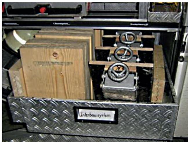
**Bild 4** | Gewährleistung eines schnellen Zugriffs im Einsatzfall – Unterbringung des Unterbausystems im Alu-Koffer eines LF10/6
