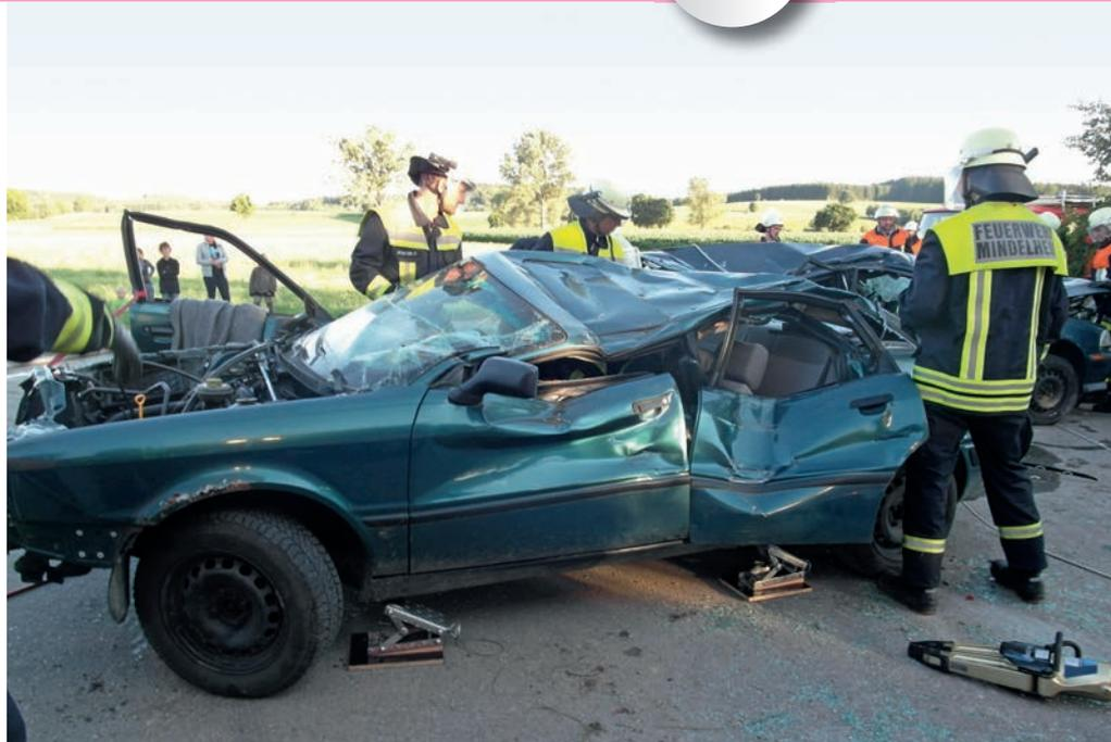
**Bild 3** | Das Unterbausystem im Praxistest – Übungseinsatz bei der FF Mindelheim
