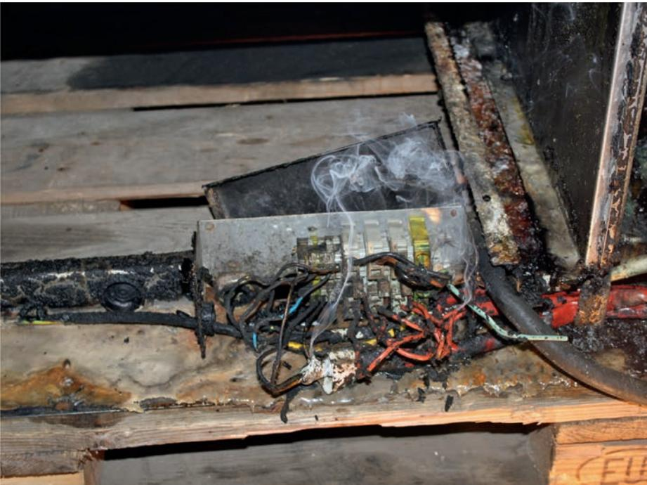
**Bild 3** | Unter Spannung steigt im Bereich des Isolationsfehlers Rauch auf.
