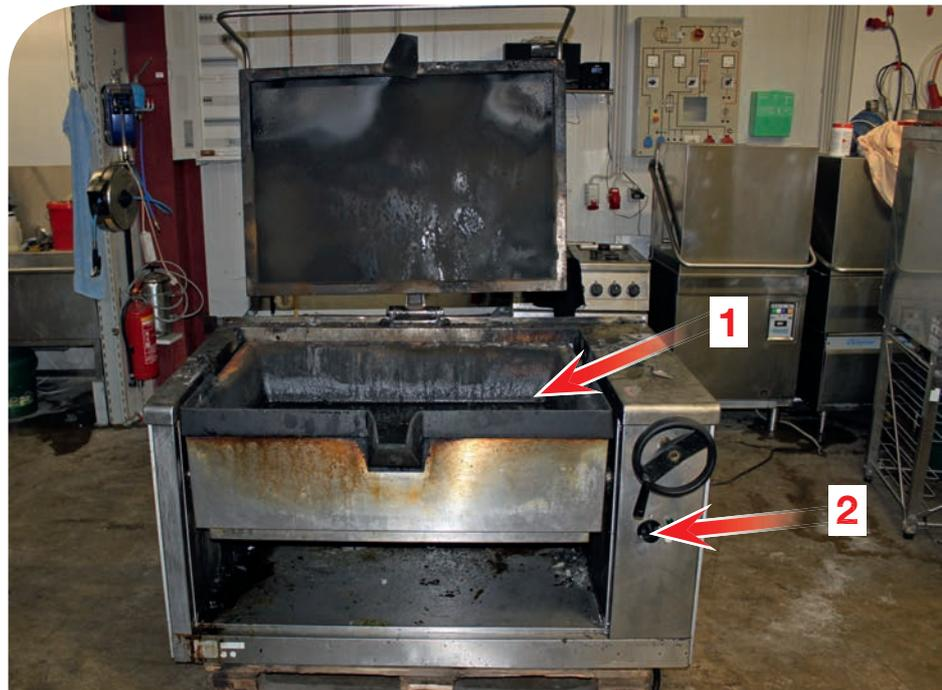
**Bild 1** | Im Tiegel (1) der Kippbratpfanne ist Fett überhitzt. Pfeil 2 deutet auf den Knauf des Reglerthermostaten.
