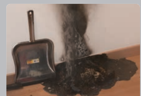
Bildsequenz 4 | Brand- schwerpunkt leinölgetränkte Lappen, die sich selbst ent- zünden, kommentiert durch Dr. Dag Leine
