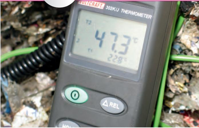
**Bild 13** | Ca. 40 cm innerhalb der Schüttung des Recyclingmaterials wurde in diesem Bereich eine Temperatur von annähernd 50 °C gemessen.
