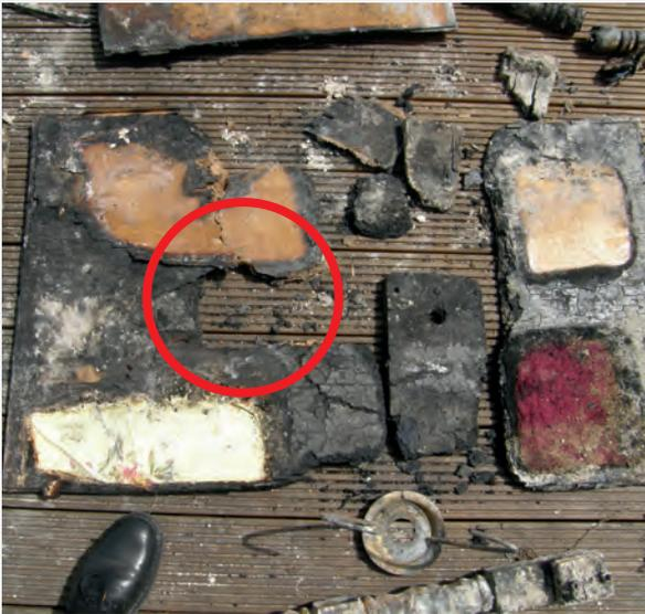
**Bild 5** | Blick auf die Oberseite der Küchentischplatte. In der Mitte ist die Durchbrennung zu erkennen (Kreis). Rechts sind noch Reste von Handtüchern vorhanden.
